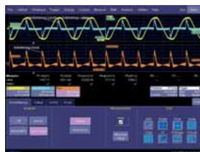
Figura 5 - La señal modulada I/Q se transfiere a la función matemática MATLAB. El fichero m-file lee como entrada la forma de onda, ejecuta una demodulación de la señal, le calcula la fase y visualiza la forma de onda resultante como función F1 en el osciloscopio para un ulterior análisis.
