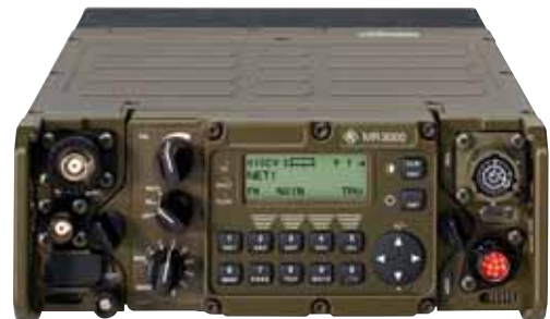
Una de las radios software digital de la familia M3xR, la M3TR, para aplicaciones tácticas
