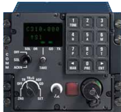
M3AR: Equipo de radio para plataformas aéreas
