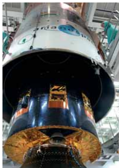
Ensamblaje del MSG2 en el lanzador Ariane
