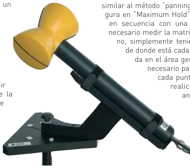
Antena de un solo eje en una plataforma rotatoria. El instrumento calcula el resultado isotrópico automáticamente a partir de las tres medidas tomadas por separado en las posiciones definidas.
