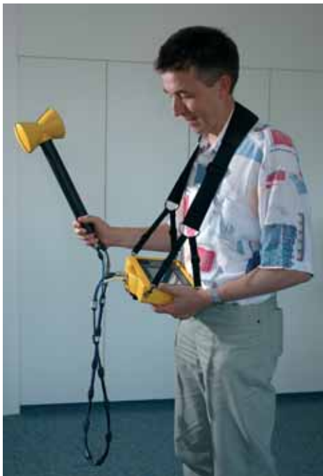
El Medidor de Radiación Selectivo SRM-3000 con una antena de un solo eje y función "Maximum Hold" activada para el método "panning"
