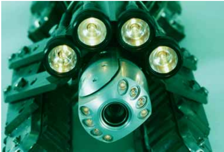
El robot Versatrax300 está indicado para inspección de tuberías
