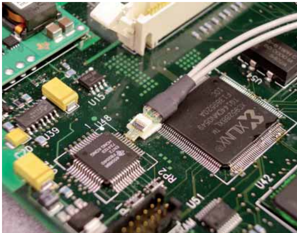
Cabezal de sonda ZIF N5425A de Agilent con punta ZIF N5426A y cinta adhesiva de poliestireno de doble cara
